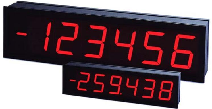
**GROSSANZEIGEN OC57-DC, OC100-DC und OC125-DC** sind 4- oder 6-stellige programmierbare Messgeräte mit  $\pm 20'000$  Messpunkten (Option bis 200'000 Punkte) und wählbaren Eingängen für diverse DC- Prozesssignale wie DMS Brücken,  $\pm 100\text{mV}$ , 1-5V, 4-20mA, etc. Sie werden mit 57mm, 100mm oder 125mm Ziffern bestückt. Unter Verwendung der Skalierkonstante kann die Anzeige in den gemessenen Prozesseinheiten wie kg, gr, lb, kN etc. skaliert werden.
