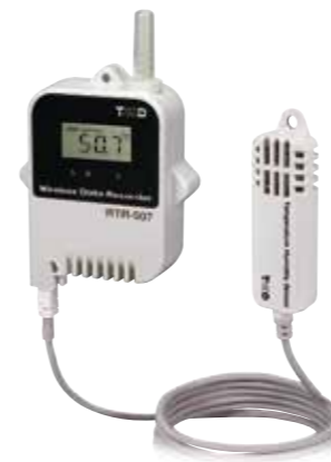
RTR-507 / RTR-507L Messbereich: Temperatur: -30 bis 80°C Feuchte: 0 bis 99 %RH Sensor: Hochpräzisions Temperatur/Feuchte Sensor (HHB-3101)
